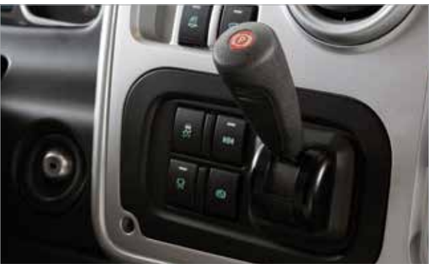
أزرار نظام التحكّم الإلكترونيّ بالثبات ESP، ومساعد الإقلاع على التلال وفرامل المحرّك مثبّنة بشكل يسمح الوصول إليها بسهولة.
